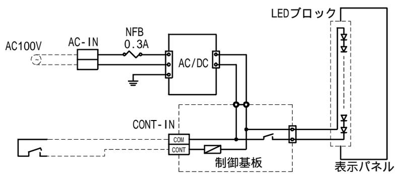
AC100V常時印加 接点制御 点灯型
