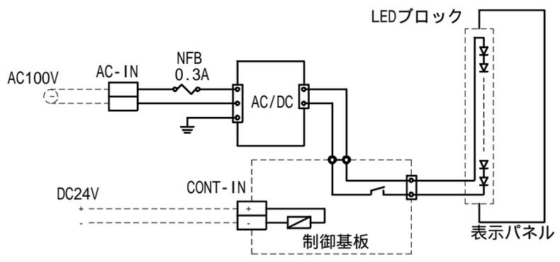
AC100V常時印加 24V入力制御 点灯型
